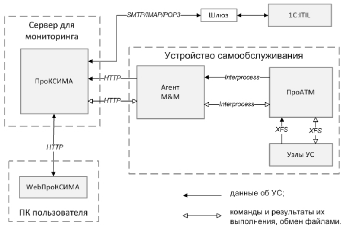
Рисунок 1. Схема взаимодействия частей мониторинга
